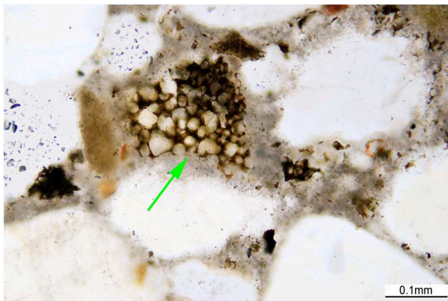
Obr. 2: Litomyšl V1 – nezhydratovaný slínek (ozn. šipkou); PPL
